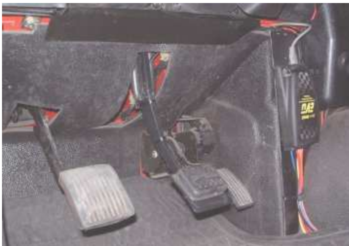
Rys. 7. Na pedale hamulca zamontowany piezoelektryczny czujnik siły, na wsporniku zamontowano sterownik EVO układu hamulcowego.
