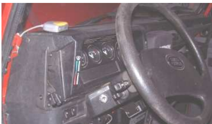
Rys. 6. Myszka elektronicznego układu hamulcowego zamontowana w samochodzie Land Rover Defender 110. Widoczny żółty przycisk służy do kilkusekundowego niezależnego uruchamiania hamulców w pojeździe holowanym - celem stabilizacji toru jazdy zestawu pojazdów.
