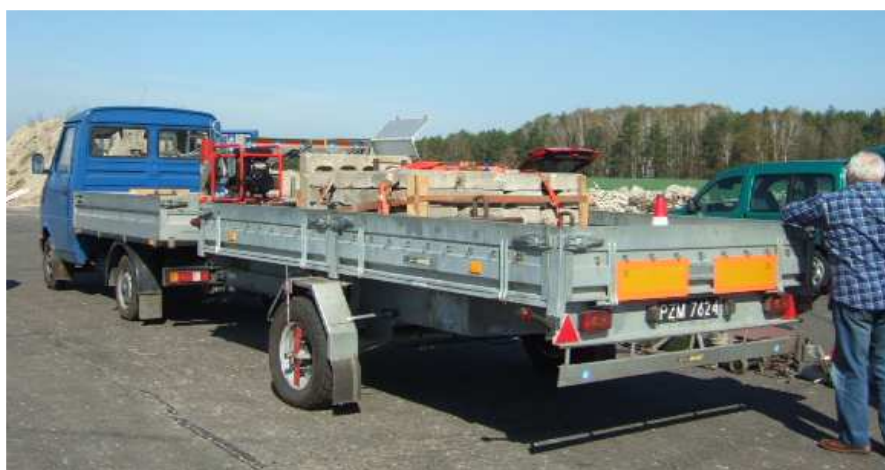
Rys. 8. Zestaw badawczy z oponami rolniczymi
