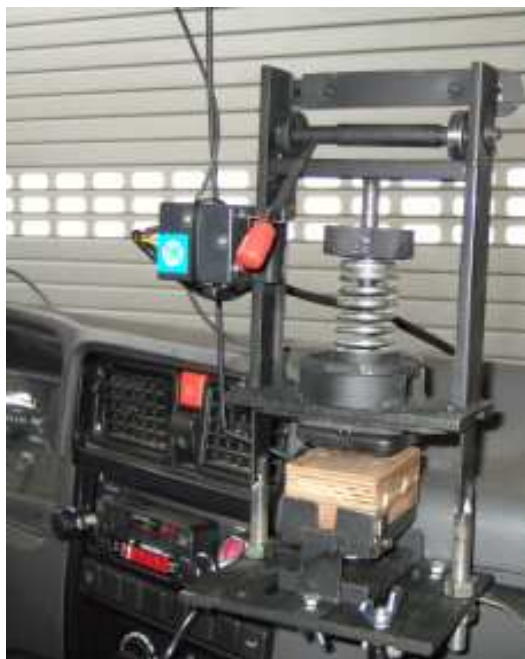
Rys. 5. AFD- urządzenie do bezpośredniego uruchamiania hamulców naczepy. Drewniany klocek dystansowy odpowiada wymiarom zewnętrznym czujnika siły Laboratorium Hamulców PIMOT.
