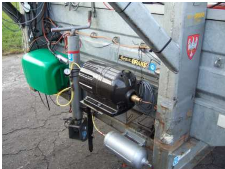
Rys. 3. Elementy układu hamulcowego zamontowane w badawczej naczepie GN2000. Pod tymczasową osłoną znajduje się moduł sprężarkowy, a pod serwomechanizmem - dodatkowy zbiornik powietrza. Widoczne manometry wskazują ciśnienie robocze w zasadniczym zbiorniku powietrza oraz w układzie hydraulicznym hamulców.
